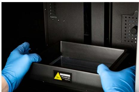
分别向内侧旋转两侧快拆旋钮，固定料槽。
