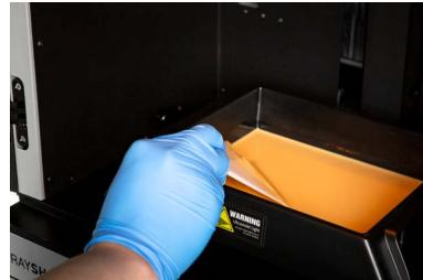
用三角刮板沿树脂槽边缘轻轻铲起被固化的一层树脂，直至露出一角。
