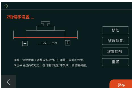
点击“设置” - “Z 轴偏移设置” - “移至底部”。打印平台将向下运动直至与料槽玻璃表面接触（最大 Z 轴行程）。
