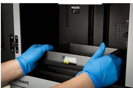
双手握住料槽把手，向上抬起，移除料槽。料槽放置在一旁时，请预先在工作台上垫一张洁净的 A4 纸，防止料槽膜受到污染或者破损。
