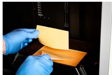
该层树脂易破碎，故不适合用镊子等工具取拿，请戴好橡胶手套后用手拿取，并合理丢弃。
