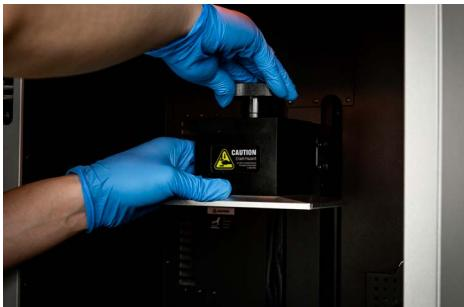
安装打印平台时，将打印平台按图中所示对准悬臂卡口，平推到底。
