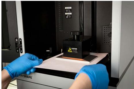
用手扯动 A4 纸四角，感受打印平台和料槽玻璃的夹紧力度，四角应均不能扯动。
