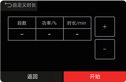
定义分段固化参数 点击“+”、“-”按钮添加/删减固化分段段数。
