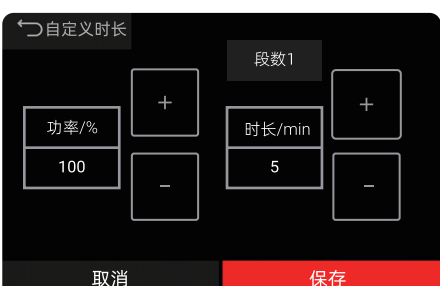
定义指定分段参数 点击“功率参数增/减按钮”，调整自定义功率数值。 点击“时长参数增/减按钮”，调整自定义时长数值。
