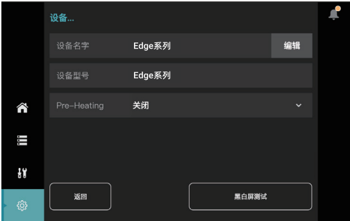
屏幕测试 在屏幕上放置一张A4 纸，点击黑白屏测试，屏幕将投射出方块阵列，检查投光有无闪烁和模糊等异常情况。
